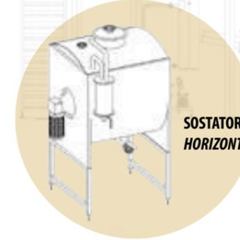
SOSTATORE A TRUOGOLO O CILINDRICO
